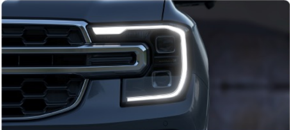
ចង្កៀងផ្នែកខាងមុខរចនាថ្មី C-Clamp ដែលរចនាឲ្យមានភាពអក្ស C ប្រភេទ Matrix LED និងចង្កៀងបំភ្លឺពេញថ្ងៃ
