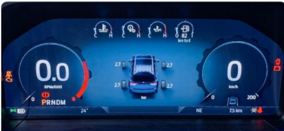
ប្រព័ន្ធកាត់សម្អាតកង់ចេយន្ត Tire Pressure Monitoring System
