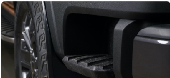
បំពាក់ឈ្នាំងតាន់ដើមផ្នែកចំហៀងខាងក្រោយងាយស្រួលឡើងចុះ រថយន្តងាយពុំចាំបាច់ឡើងចុះតាមកង់រថយន្តទៀតទេ
