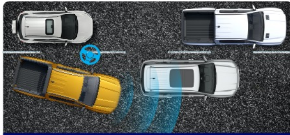
ប្រព័ន្ធឆ្លងសញ្ញាគ្រោះថ្នាក់ពេលមានឧបសគ្គ និងប្រព័ន្ធជំនួយលើដៃចម្លងបញ្ចៀសរេច្បូរគ្រោះថ្នាក់
