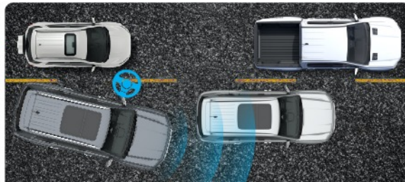
ប្រព័ន្ធគ្រប់គ្រងគម្លាតចម្ងាយមានរបសក្តិ និងប្រព័ន្ធជំនួយលើដៃត្រួតពិនិត្យស្រោចគ្រោះគ្នា
