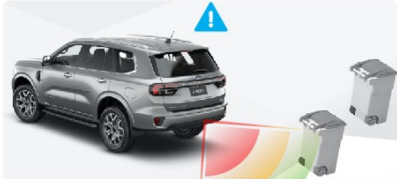
ប្រព័ន្ធចាប់ប្រៀងបន្ទាន់ពេលឆយក្រោយដោយស្វ័យប្រវត្តិ
