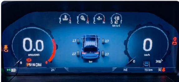
ប្រព័ន្ធកាត់សម្អាតកង់រថយន្ត Tire Pressure Monitoring System
