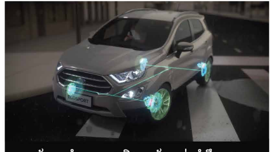
ប្រព័ន្ធប្រឆាំង ABS និងប្រព័ន្ធទប់លំនឹងថយន្តពេលបើកបរលើផ្លូវកោង និងអិល
