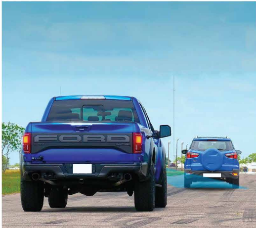
ប្រព័ន្ធបន្តយល្បឿន និងរក្សាចំលាតស្មើគ្នា ដោយឈប់ និងទៅមុខដោយស្វ័យប្រវត្តិ
